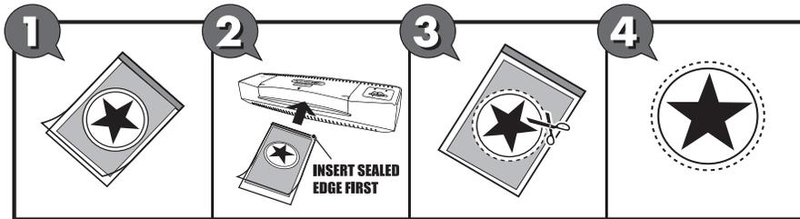
Placer les articles plus petits ou de forme irrégulière au centre de la poche appropriée et tailler après le laminage. **NE PAS DÉCOUPER LA POCHETTE DE LAMINAGE AU FORMAT DE L'ARTICLE AVANT LE LAMINAGE.**
