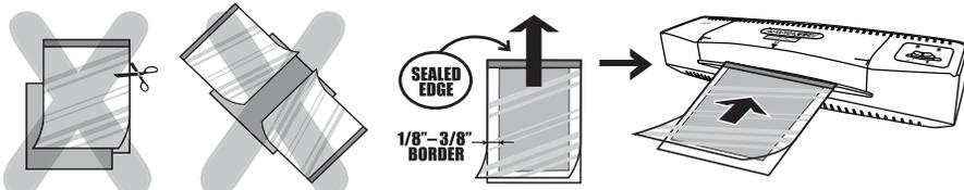
Placer correctement l'article en utilisant seulement 1 pochette de laminage par article.
